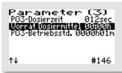
Um einzustellen wie lange der Fällmittelvorrat ausreicht, wird mit den -Tasten die Zeile „VORRAT DOSIERMITTEL“ ausgewählt.
