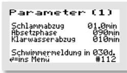
Bei Eingabe von Passwort 2 wird in der untersten Zeile der/die angeschlossenen Schwimmerschalter mit der eingestellten Wartezeit bis zur Warnung angezeigt.
