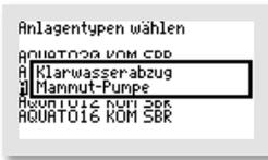
Wird für den Klarwasserabzug ein Druckluftheber genutzt, wählen Sie im Fenster „KLARWASSERABZUG“ mit den
