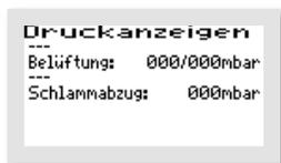
In diesem Menü wird der jeweilige Druck während des letzten Zyklus angezeigt. Belüftungs- und Überschussschlammgegendruck werden jeweils bei den einzelnen Vorgängen gespeichert. Es wird immer nur die Druckmessung der jeweiligen letzten Phase angezeigt. Für die Belüftung werden jeweils 2 Werte angezeigt, der minimale und der maximale Druck. Ist die Drucküberwachung ausgeschaltet, entfällt dieses Menü.
