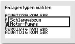
Wird der Überschussschlammabzug mit einer Tauchmotorpumpe statt des Drucklufthebers ausgerüstet, wählen Sie im Fenster „SCHLAMMABZUG“ bitte „MOTOR-PUMPE“.
