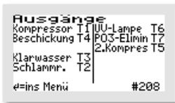
Wurde, wie im Beispiel, die Funktion „UV-Lampe“ auf den Ausgang „T 6“ gelegt, muss auch der elektrische Anschluss der Hygienisierung (hier mit UV-Lampe) auf den Kontakt T 6 gelegt sein. Ebenso wurde im Beispiel die Funktion „KLARWASSERPUMPE“ auf den Ausgang „T1.3“ gelegt, also muss auch der elektrische Anschluss der Klarwasserpumpe auf den Kontakt T1.3 gelegt sein.
