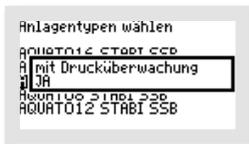
Schalten Sie die Überwachung im Fenster "MIT DRUCKÜBERWACHUNG" mit der Auswahl von "JA" ein, gibt es bei Ausfall des Gerätes eine Fehlermeldung.
