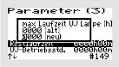
Mit der (mittleren) -Taste kommen Sie ins Menü. Die Zeile „RESTLAUFZEIT“ wird mit den -Tasten ausgewählt.
