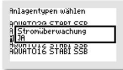
Schalten Sie diese Überwachung im Fenster „STROMÜBERWACHUNG“ mit der Auswahl von „JA“ ein, gibt es bei Ausfall des Gerätes eine Fehlermeldung.
