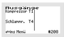
In diesem Beispiel wird der Verdichter über den Ausgang T1 gesteuert und die Schlammrückführung über den Ausgang T4.
