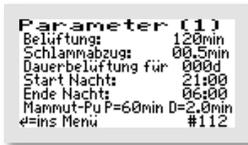
Im Beispiel ist eine zusätzliche Mammut-Pumpe ausgewählt. Über „MAMMUT-PU P=xxMIN D=x.xMIN“ können die Zeitintervalle für PERIODE (= Pausenzeit) und DAUER (= Einschaltzeit) geändert werden.
