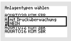
Anschließend werden Sie im nächsten Fenster „MIT DRUCK-ÜBERWACHUNG“ gefragt, ob die Anlage auf Druck überwacht werden soll.
