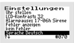
Hier wird die Sprache der Steuerung ausgewählt. Die Steuerung ist vorbereitet für mehrere Sprachen. Einprogrammierte Sprachen sind zurzeit:
