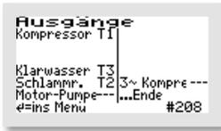
Wenn eine oder mehrere zusätzliche Funktionen – in diesem Beispiel die Tauchmotor-Pumpe und der Dreiphasenkompressor – ausgewählt wurden, muss diesen Funktionen noch jeweils ein eigener Ausgang zugewiesen werden. Dies ist ersichtlich an den Leerzeichensymbolen „---“ hinter den Aggregaten.
