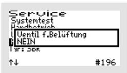
Nach Auswahl des Grundtyps wird im Fenster „VENTIL F. BELÜFTUNG“ abgefragt, ob die Belüftung mit einem Ventil angesteuert wird. Im Standardfall wird die Belüftung ohne Ventil angesteuert. Dazu bestätigen Sie die Auswahl „NEIN“ mit der Taste
