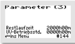
Im Menü Parameter 3 werden die „RESTLAUFZEIT“ der UV-Lampe und die Gesamtlaufzeit der UV-Leuchte als „UV-BETRIEBSSTD.“ angezeigt. Hier wird die Einstellungen von „RESTLAUFZEIT“ nach dem Wechsel der UV-Röhre wieder auf 2000 Stunden eingestellt.
