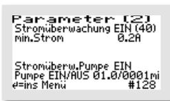
In diesem Beispiel ist eine zusätzliche Tauchmotorpumpe („MOTOR-PUMPE“) angeschlossen. Die Stromüberwachung für diese Pumpe ist eingeschaltet. Die Pumpenlaufzeiten sind zeitlich getaktet, jeweils 1 Minute EIN und 1 Minute AUS.
