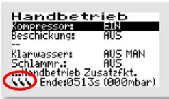
Links unten sind 3 Schwimmerschalter-Symbole mit der aktuellen Schwimmerstellung sichtbar.
