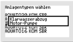
Wird der Klarwasserabzug mit einer Tauchmotorpumpe statt des Drucklufthebers ausgerüstet, wählen Sie im Fenster „KLARWASSERABZUG“ bitte „MOTOR-PUMPE“.
