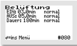
Im Menü „BELÜFTUNG“ werden die ausgewählten Belüftungsintervalle im Normalbetrieb angezeigt, d. h. es wird angezeigt, für wie viele Minuten die Belüftung jeweils im Wechsel „EIN“ bzw. „AUS“ geschaltet wird (Taktung).
