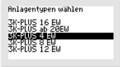
Alle Parameter für den Klärzyklus werden durch diese Auswahl automatisch voreingestellt, können aber bei Bedarf nachreguliert werden.
