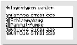
Wird für den Überschussschlammabzug ein Druckluftheber genutzt, wählen Sie im Fenster „SCHLAMMABZUG“ mit den
