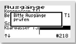
Wird ein Ausgang doppelt ausgewählt, ertönt ein Warnsignal und beim Versuch das Menü zu verlassen, erscheint mit einem weiteren Warnton ein Fenster mit der Warnung „BITTE AUSGÄNGE PRÜFEN“, zudem wird das Menü nicht verlassen, sodass die Auswahl in den betreffenden Zeilen korrigiert werden kann.
