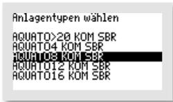
Danach wählen Sie als „ANLAGENTYP“ die gewünschte bzw. erforderliche EW-Zahl (nach Klärtechnischer Berechnung) mit den -Tasten aus. Wenn die Markierung (= schwarzer Balken) auf der richtigen EW-Zahl steht, bestätigen Sie mit der -Taste. Steht die erforderliche EW-Zahl nicht direkt zur Auswahl, wählen Sie den nächstgrößeren Eintrag.
