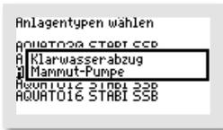
Wird für den Klarwasserabzug ein Druckluftheber genutzt, wählen Sie im Fenster „KLARWASSERABZUG“ mit den -Tasten bitte „MAMMUT-PUMPE“.
