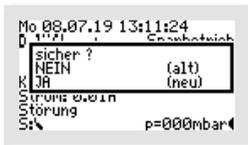
Bei der Auswahl von „JA“ wird auch die Fehleranzeige im Display gelöscht und das rote Blinken der LED erlischt.
