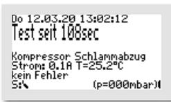
Der Test läuft vollautomatisch als Standard-Test ab. Er ist unabhängig vom gewählten Programm. Die einzelnen Funktionen werden nacheinander (jeweils ca. 15 Sekunden) geprüft. Funktioniert alles fehlerfrei, kommt keine Alarmmeldung.
