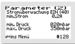
In diesem Menü kann die Stromüberwachung „AUS“ oder „EIN“ geschaltet werden. Im Standardfall ist die Stromüberwachung auf „EIN“ gestellt.
