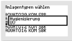
Soll eine Hygienisierung mit einer UV-Lampe durchgeführt werden, wählen Sie im Fenster „HYGIENISIERUNG“ mit den
