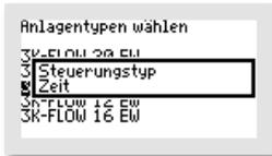
Für den Betrieb einer **Wirbelschwebe-** oder **Festbettenanlage** sollte standardmäßig der Steuerungstyp „ZEIT“ ausgewählt werden. Nur für den Betrieb mit einer zusätzlichen PUMPE (siehe unten) kann die Einstellung SCHWIMMER erforderlich sein.
