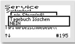
Als letztes Fenster in diesem Menü öffnet sich „TAGEBUCH LÖSCHEN“, hier werden bei der Auswahl von „JA“ alle Einträge und Einstellungen gelöscht. Danach startet die Steuerung wieder neu mit der Inbetriebnahme.
