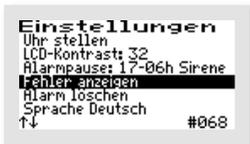
Über den Menüpunkt „FEHLER ANZEIGEN“ wird das Fehlerlogbuch aufgerufen.
