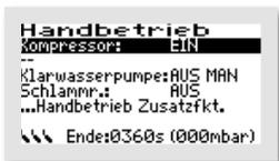
Das Menü Handbetrieb besteht aus 2 Fenstern. Mit den -Tasten kann zwischen den stets vorhandenen Parametern „KOMPRESSOR“, „KLARWASSERPUMPE“ sowie „SCHLAMMR“ (= Schlammrückführung) im ersten Fenster (mit den Standardfunktionen) ausgewählt werden, indem der schwarze Balken auf den gewünschten Eintrag gesetzt wird.
