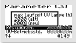
Mit der -Taste wird der Menüpunkt aufgerufen. Die Ziffern werden einzeln mit den -Tasten geändert und mit der -Taste auch jeweils zifferweise bestätigt.
