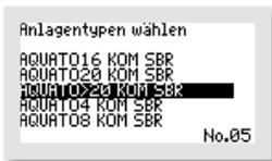
Für die Anlagengrößen von 21 bis 50 EW treffen Sie bitte die Auswahl „AQUATO>20 KOM SBR“. Die Zyklus-Voreinstellungen für die Anlagengrößen von 21 bis 50 EW sind gleich, die unterschiedlichen benötigten Luftmengen werden durch unterschiedliche Größen und Mengen von Membranbelüftern und Verdichtern erreicht. Bei Bedarf können diese Einstellungen nachreguliert werden.
