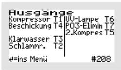
Wurde, wie im Beispiel, die Funktion „UV-Lampe“ auf den Ausgang „T 7“ gelegt, muss auch der elektrische Anschluss der Hygienisierung (hier mit UV-Lampe) auf den Kontakt T 7 gelegt sein.
