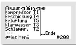
Zusätzlich wird in diesem Beispiel die Belüftung über den Ausgang T5 gesteuert.
