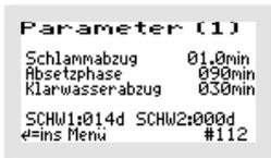
Im Beispiel wird die Schwimmermeldung für Schwimmer 1 nach 14 Tagen ohne Schaltvorgang des Schwimmers aktiv. Die Meldung für Schwimmerschalter 2 ist ausgeschaltet.
