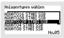
Für die Anlagengrößen von 21 bis 50 EW treffen Sie bitte die Auswahl „AQUATO>20 STABI SSB“. Die Zyklus-Voreinstellungen für die Anlagengrößen von 21 bis 50 EW sind gleich, die unterschiedlichen benötigten Luftmengen werden durch unterschiedliche Größen und Mengen von Membranbelüftern und Verdichtern erreicht. Bei Bedarf können diese Einstellungen nachreguliert werden.
