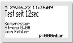
Der Test läuft vollautomatisch ab. Die einzelnen Funktionen werden nacheinander (jeweils ca. 15 Sekunden) geprüft. Funktioniert alles fehlerfrei, kommt keine Alarmmeldung.
