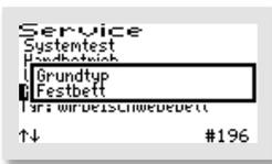
Als erstes wird nach dem „GRUNDTYP“ der Anlage gefragt. Mit den
