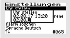
Die Uhr arbeitet quartzgesteuert. Sie sollte bei der Wartung mit geprüft werden. Auf die richtige Einstellung der Uhr sollte geachtet werden, da die Auswertung der Wartung dadurch erleichtert wird.
