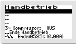
Je nach Voreinstellung können im 2. Handbetrieb-Fenster unterschiedliche Menüpunkte, wie z. B. „3~KOMPRESSOR“, ausgewählt werden, indem der schwarze Balken auf den gewünschten Eintrag gesetzt wird. Dann wird diese Funktion mit der
