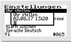
Die erste Ziffer kann mit den -Tasten geändert werden. Ist der richtige Wert eingestellt, wird mit der mittleren -Taste die Ziffer übernommen. Auf die gleiche Art werden allen folgenden Ziffern ausgewählt.
