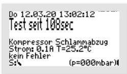
Der Test läuft vollautomatisch als Standard-Test ab. Er ist unabhängig vom gewählten Programm. Die einzelnen Funktionen werden nacheinander (jeweils ca. 15 Sekunden) geprüft. Funktioniert alles fehlerfrei, kommt keine Alarmmeldung.
