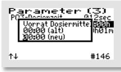
Mit der -Taste wird der Menüpunkt aufgerufen. Die Ziffern werden einzeln mit den -Tasten geändert und mit der -Taste auch jeweils ziffernweise bestätigt.
