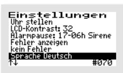
Hier wird die Sprache der Steuerung ausgewählt. Die Steuerung ist vorbereitet für mehrere Sprachen. Einprogrammierte Sprachen sind zurzeit:
