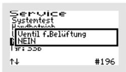
Nach Auswahl des Grundtyps wird im Fenster „VENTIL F. BELÜFTUNG“ abgefragt, ob die Belüftung mit einem Ventil angesteuert wird. Im Standardfall wird die Belüftung ohne Ventil angesteuert. Dazu bestätigen Sie die Auswahl „NEIN“ mit der Taste
