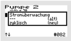
Die Option „ZYKLISCH“ dient dazu, bei Pumpen mit angebaubtem Schwimmerschalter zu prüfen, ob die Pumpe korrekt arbeitet. Dazu kann die Anzahl der Zyklen eingestellt werden, in denen die Funktion abgefragt wird, bevor eine Fehlermeldung auftritt. Im Beispiel sind es 24 Zyklen (vgl. dazu Kapitel 13.3.4.3, „PARAMETER (2)“).
