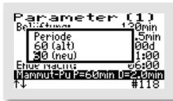
Zunächst kann die Länge der Pumpspause „PERIODE“ in Minuten eingegeben werden, direkt danach die „DAUER“ der Einschaltzeit ebenfalls in Minuten.
