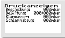
In diesem Menü wird der jeweilige Druck während des letzten Zyklus angezeigt. Beschickungs-, Klarwasser- und Überschuss-schlammgegendruck werden jeweils bei den einzelnen Vorgängen gespeichert. Es wird immer nur die Druckmessung der jeweiligen letzten Phase angezeigt.
