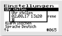
Die erste Ziffer kann mit den -Tasten geändert werden. Ist der richtige Wert eingestellt, wird mit der mittleren -Taste die Ziffer übernommen. Auf die gleiche Art werden allen folgenden Ziffern ausgewählt.
