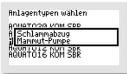
Wird für den Überschussschlammabzug ein Druckluftheber genutzt, wählen Sie im Fenster „SCHLAMMABZUG“ mit den -Tasten bitte „MAMMUT-PUMPE“.
