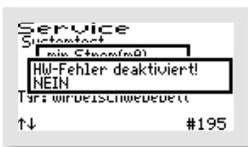
Im nächsten Fenster „HW-Fehler deaktiviert“ kann die Hochwasser-Fehler-Meldung deaktiviert werden. Dies ist in der Regel nicht erforderlich. Nach Bestätigen der Auswahl öffnet sich automatisch das nächste Fenster.
