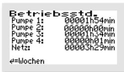
Im Menü „BETRIEBSSTUNDEN“ werden die Betriebsstunden der jeweiligen Aggregate angezeigt. Die Betriebsstunden werden hochgezählt, wenn die Steuerung den Kompressor (bzw. eventuell eine Pumpe) eingeschaltet hat. Die Anzeige erfolgt in Stunden und Minuten.
