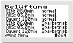
Auch für den Sparbetrieb wird das Belüftungsintervall angezeigt, d. h. für wie viele Minuten die Belüftung „EIN“ bzw. „AUS“ geschaltet wird. Außerdem wird die Gesamtdauer der Belüftung im Sparbetrieb („DAUER: XXXmin SPARBETRIEB“) angezeigt.
