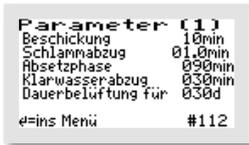
Im Beispiel wird die Dauerbelüftung für 30 Tage eingeschaltet.
