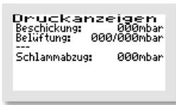
Ist statt des betreffenden Hebers eine Beschickungs-, Schlamm- und/oder Klarwasserpumpe angeschlossen, wird dieser Ausgang nicht als Druckausgang angezeigt.
