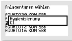
Ebenso können Sie eine Hygienisierung mit einem Desinfektionsmittel, wie z. B. Chlor, mit der Option „CL“ auswählen.
