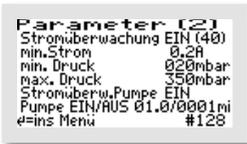
Ist eine zusätzliche Motor-Pumpe ausgewählt, werden die erforderlichen Anzeigen in den beiden unteren Zeilen dargestellt.
