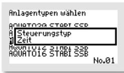
Mit dem Fenster „STEUERUNGSTYP“ können Sie zwischen einem zeit- oder einem schwimmergesteuerten Zyklus auswählen. In der zweiten Zeile kann der gewünschte Steuerungstyp eingestellt werden. Durch Betätigen der -Tasten wird zwischen „ZEIT“ oder „SCHWIMMER“ ausgewählt. Mit der -Taste wird der gewählte Steuerungstyp übernommen. Mit der Einstellung „ZEIT“ wird der Ablauf des Zyklus nur über die Zeit gesteuert, mit der Einstellung „SCHWIMMER“ ist er zusätzlich schwimmergesteuert.
