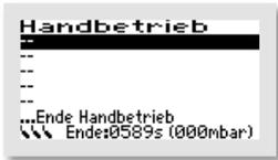
Wurde keine Zusatzfunktion ausgewählt, wird auch keine Funktion in diesem Fenster angezeigt. Dann kann der Handbetrieb direkt über den Menüpunkt „...ENDE HANDBETRIEB“ beendet werden.
