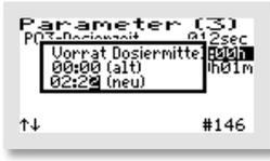
Im Beispiel ist ein Dosiermittelvorrat mit einer Gesamtlaufzeit der Dosierpumpe von 2 Stunden und 22 Minuten eingestellt.
