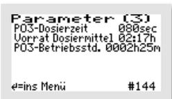
Im Menü Parameter 3 werden die „PO3-DOSIERZEIT“ pro Zyklus, der „VORRAT DOSIERMITTEL“ und die Gesamtlaufzeit der Dosierpumpe als „PO3-BETRIEBSSTD.“ angezeigt. Hier können auch die Einstellungen von „PO3-DOSIERZEIT“ pro Zyklus und „VORRAT DOSIERMITTEL“ angepasst werden.
