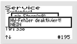
Im nächsten Fenster „HW-Fehler deaktiviert“ kann die Hochwasser-Fehler-Meldung deaktiviert werden. Dies ist in der Regel nicht erforderlich. Nach Bestätigen der Auswahl öffnet sich automatisch das nächste Fenster.
