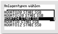
Danach wählen Sie als „ANLAGENTYP“ die gewünschte bzw. erforderliche EW-Zahl (nach Klärtechnischer Berechnung) mit den -Tasten aus. Wenn die Markierung (= schwarzer Balken) auf der richtigen EW-Zahl steht, bestätigen Sie mit der -Taste. Steht die erforderliche EW-Zahl nicht direkt zur Auswahl, wählen Sie den nächstgrößeren Eintrag.
