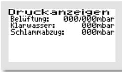
In diesem Menü wird der jeweilige Druck während des letzten Zyklus angezeigt. Der Klarwasser- und der Überschussschlammgedruck werden jeweils bei den einzelnen Vorgängen gespeichert. Es wird immer nur die Druckmessung der jeweiligen letzten Phase angezeigt.
