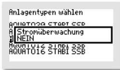
Haben Sie bei der Abfrage „3-KOMPRESSOR“ „JA“ gewählt, folgt im Fenster „STROMÜBERWACHUNG“ die Abfrage, ob der Drehstromverdichter auf Stromfehler überwacht werden soll.
