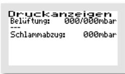
Ist statt des betreffenden Hebers eine Schlamm- und/oder Klarwasserpumpe angeschlossen, wird dieser Ausgang nicht als Druckausgang angezeigt.
