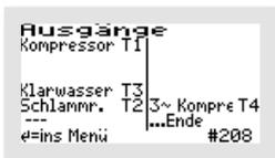
In diesem Beispiel wird der Verdichter über den Ausgang T1 gesteuert, der Klarwasserabzug über den Ausgang T3 und der Schlammabzug über den Ausgang T2. Dazu wird ein Dreiphasenkompressor über den Ausgang T4 angesteuert.
