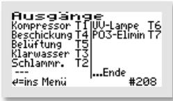
In diesem Beispiel wird der Verdichter über den Ausgang T1 gesteuert, die Beschickung über den Ausgang T4, die Belüftung über den Ausgang T5, der Klarwasserabzug über den Ausgang T3 und der Schlammabzug über den Ausgang T2. Dazu wird eine UV-Lampe über den Ausgang T6 angesteuert sowie die PO3-Elimination über den Ausgang T7.
