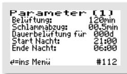
In diesem Menü wird die Dauer der Gesamtblüfungsphase und des Schlammabzugs angezeigt, der Beginn und das Ende des Nachtbetriebes sowie je nach Einstellung weitere Parameter.
