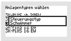
Mit dem Fenster „STEUERUNGSTYP“ können Sie zwischen einem zeit- oder einem schwimmergesteuerten Zyklus auswählen. Durch Betätigen der -Tasten wird zwischen „ZEIT“ oder „SCHWIMMER“ ausgewählt. Mit der -Taste wird der gewählte Steuerungstyp übernommen.
