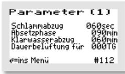
In diesem Menü wird die Dauer der folgenden Zyklus-Phasen angezeigt:
