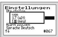
Der akustische Alarm ist standardmäßig von 17.00 Uhr bis 6.00 Uhr abgeschaltet. In dieser Zeit werden Fehler nur optisch angezeigt. Diese Einstellung kann im Menüpunkt „ALARMPAUSE“ geändert werden.
