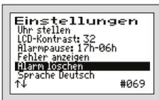
Ist eine Störung (ein Alarm) aufgetreten, so kann die Alarmmeldung nach dem Markieren der Zeile „ALARM LÖSCHEN“ durch Betätigen der -Taste zurückgesetzt werden. Es öffnet sich dann für ca. 1 Sekunde ein Fenster mit der Meldung „OK“ und anschließend wechselt die Anzeige im Menü auf „KEIN FEHLER“. Das rote Blinken der LED erlischt und im Standardfenster ist die Fehlermeldung gelöscht.
