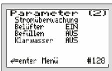
In diesem Menü kann die Stromüberwachung „AUS“ oder „EIN“ geschaltet werden. Im Standardfall ist die Stromüberwachung auf „EIN“ gestellt.
