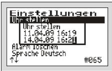
Um die Uhrzeit und/oder das Datum zu korrigieren, wählen Sie mit den -Tasten die Zeile „UHR STELLEN“ aus. Ist die Markierung (=schwarzer Balken) auf dem gewünschten Eintrag, wird mit der mittleren -Taste das Fenster zum Anpassen der Werte geöffnet.
