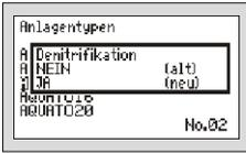
Ist eine „DENITRIFIKATION“ gewünscht/erforderlich, kann diese im nächsten Fenster zugeschaltet werden. In der zweiten Zeile „(NEU)“ kann die gewünschte Option ausgewählt werden. Die Auswahl zwischen „JA“ oder „NEIN“ erfolgt mit den -Tasten. Mit der mittleren -Taste wird der gewählte Zustand übernommen. „JA“ bedeutet, die Anlage läuft mit Denitrifikationsphase, bei „NEIN“ ist diese Phase abgeschaltet.
