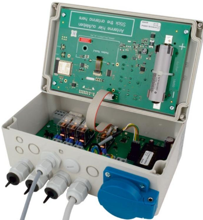
Abbildung 3: Steuerung K-Pilot 2.4 geöffnet
