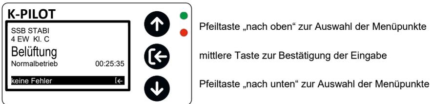
Abbildung 19: Bedientasten
